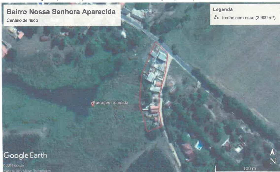
Fig.3: O polígono em vermelho destaca a área de aproximadamente 3.900 metros com ocupação populacional correndo o risco de inundação em um período de longos volumes de águas pluviais, potencializada com a barragem já rompida no passado.
