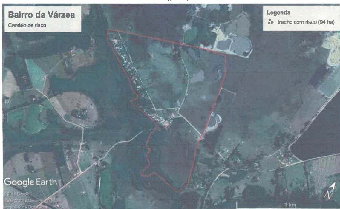
Fig.5: O polígono em vermelho destaca a área de aproximadamente 94 ha provável de alagamento, com registros no passado e podendo ocorrer no futuro caso ocorra um grande volume de águas pluviais.
