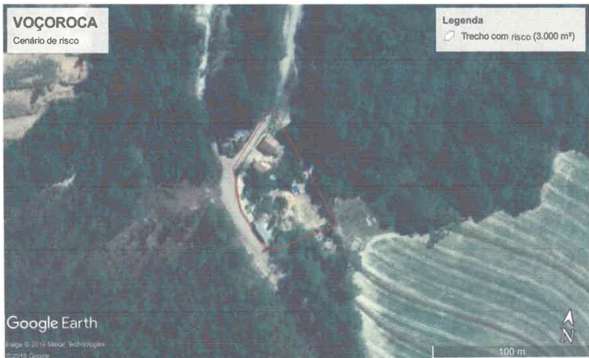
Fig.7: Em uma área de aproximadamente 3.000 m 2 há um trecho de avançado processo erosivo, apresentando voçorocas com risco iminente de aumentar, trazendo prejuízos à vida das pessoas que residem irregularmente no local.
